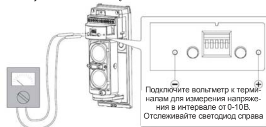
Рис. 6 настройка с использованием вольтметра
